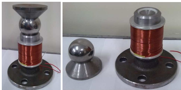
Obr. 15 Elektromagnetický centrální sférický kloub
