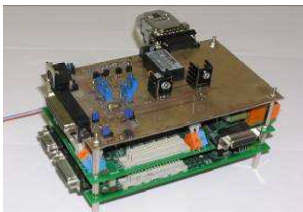
Obr.3 DSP regulátor vysokootáčkového pohonu s TMS320F2812 s přídatnou kartou pro vyhodnocení úhlového natočení rotoru
