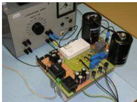
Obr.2 Experimentální IGBT střídač pro vysokootáčkový pohon
