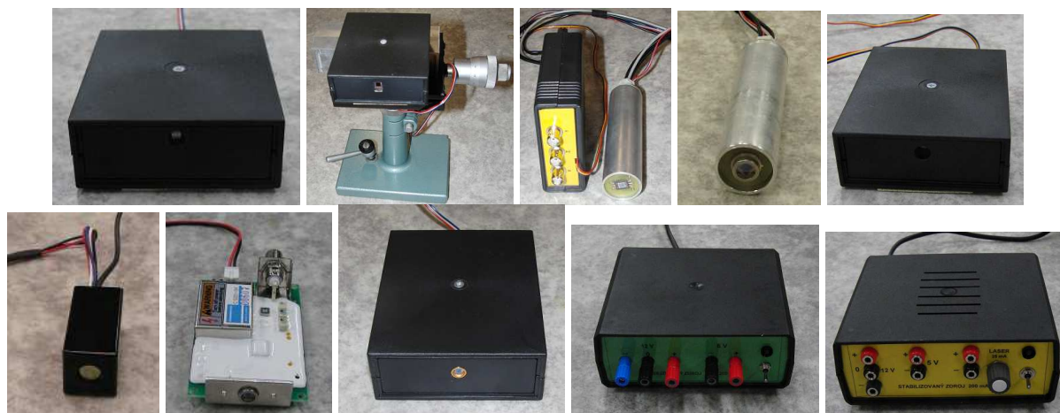
Obr 3 Ukázky příkladů zabudování jednotlivých senzorů, včetně nezbytné elektroniky a zdrojů. Zleva nahoře: 1D PSDS 6873, čtyřdioda S 6695-01, 2D PSD S2044, 2D PSD S 7848-01, senzor barvy. Zleva dole: fotonásobič H 5783, lavinová fotodioda C 5331-04, senzor vlnové délky WS7.56-TO5, stabilizovaný zdroj 5V/12V, stabilizovaný zdroj 5V/12V s ovladačem výkonu laseru.
