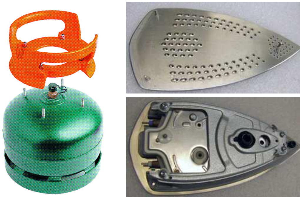
Obr. 9 Příklad použití přivařování svorníků při výrobě domácích elektrických spotřebičů a přístrojů
