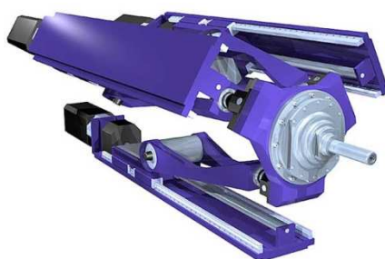
Obr. 5 Naklápěcí hlava Z3 sprint (pohyblivost \pm 30^\circ )
