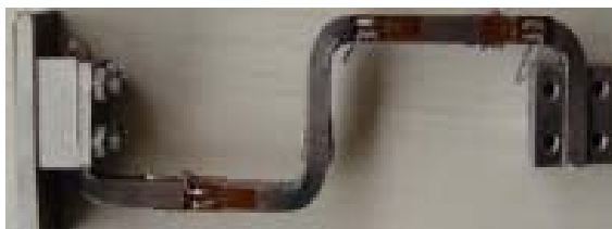
Obr. 4 Detail tenzometrického S snímače
