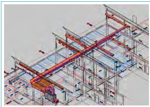
Obr. 6.19 Návrh vzduchotechniky ZŠ Slivenec (zdroj: Atrea, autor návrhu VZT: Ing. Zdeněk Zikán)
