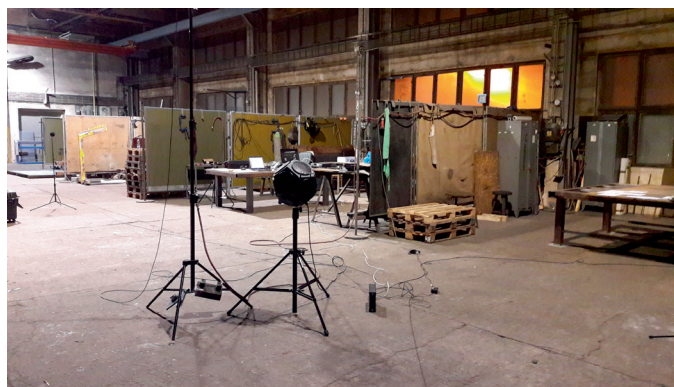
Obr. 6a Uspořádání měření ve výrobní hale bez absorbéru s volným prostorem kolem zdroje hluku
