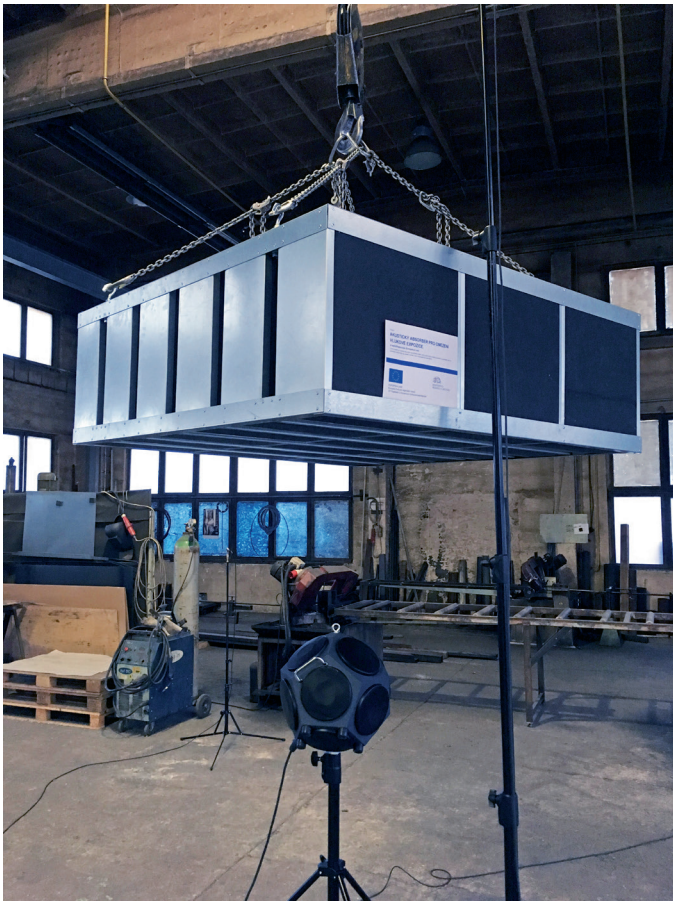
Obr. 2b Vlevo umístění absorberu ve výrobní hale, výška absorberu 2,5 m nad podlahou, všesměrový zdroj hluku; vpravo je část výkresové dokumentace, příčný pohled a horizontální řez Fig. 2b On the left is position of the absorber in the production hall, absorber at the height of 2.5 m above the floor, omnidirectional source of noise; on the right is part of the technical documentation, side view and horizontal cross-section
