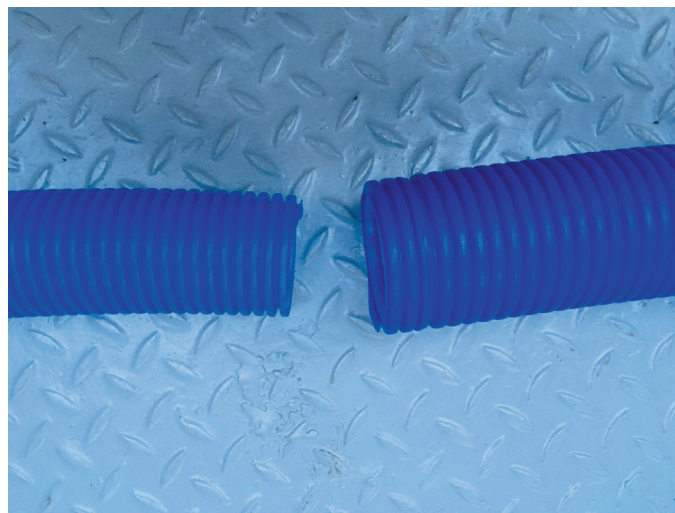
Obr. 9 Rozdílnost tvarování vzduchovodů H4 průměru 63 a 77 mm Fig. 9 Differences in the shapes of H4 air ducts with diameters 63 and 77 mm
